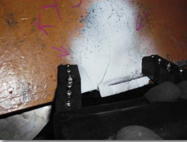
Şekil Yorulma test ve analizinde bulunan çatlak
