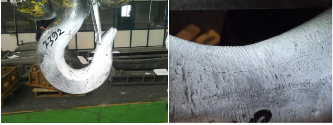
Resim 5-C kancada bulunan çatlaklar
