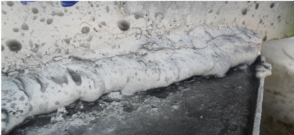
Şekil 2- Ağaç sökme makinası yorulma çatlakları
