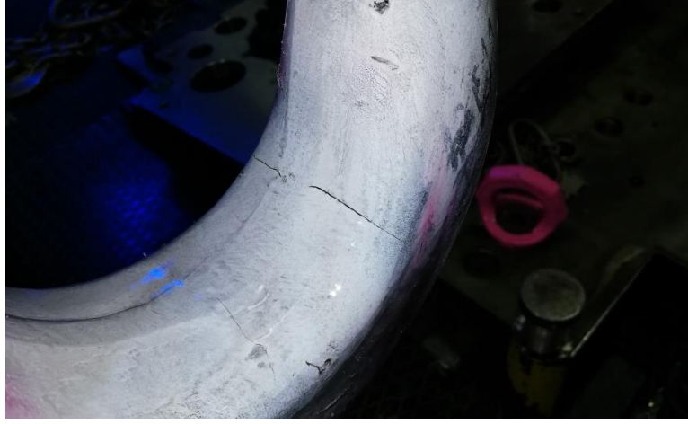
ekil 11- Vin kancalarında yorulma atlaėı
