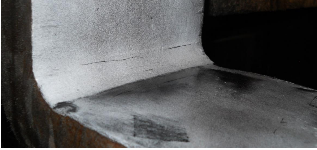
Şekil 7- Forklift çatalı büküm bölgesinde çatlak
