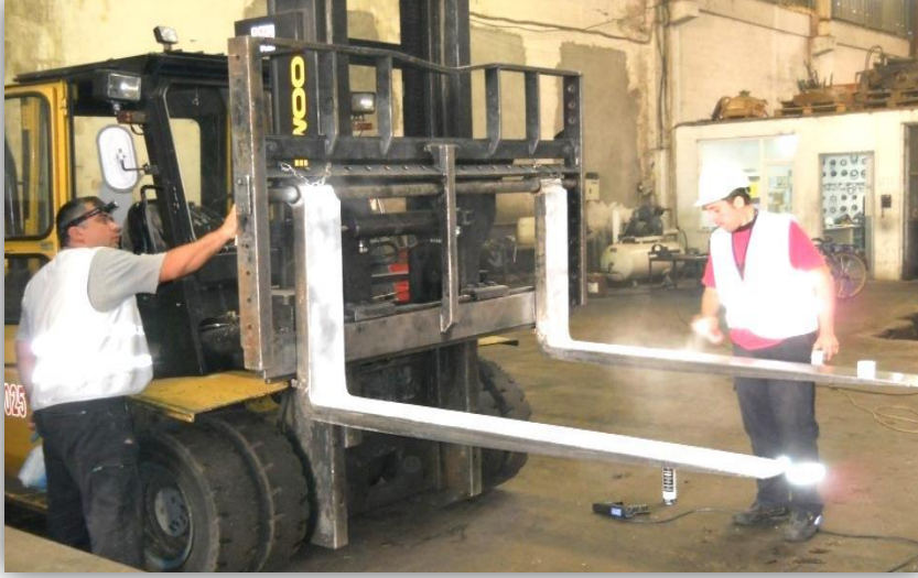
Fotoğraf 1. Manyetik Parçacık Testinin Uygulanması
