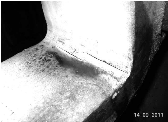
Resim 2. Forklift çatallarında bulunan çatlaklar
