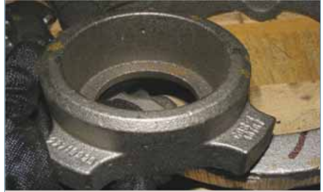
Fotoğraf 7. Tahribatsız Muayene Personeli Sınavında Kullanılan Uygulama Parçası
