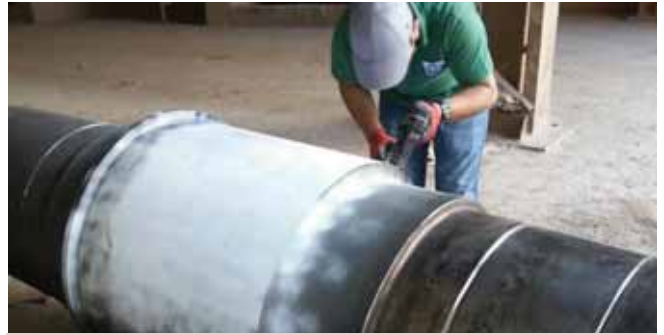
Resim 1. Manyetik Parçacık Testinin Uygulanması
