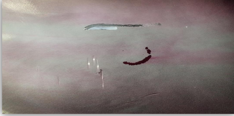
Şekil 10. Darbe Alan ve Bakımı Yapılan Paslanmaz Fikse Kazanında Penetrant Testi ile Tespit Edilen Çatlak
