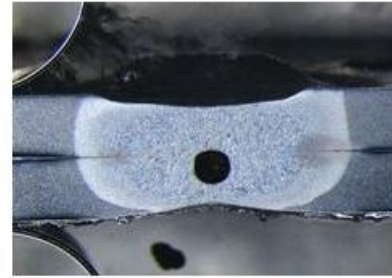
Schnittbild des Schweißpunktes mit Pore in Fügeebene
