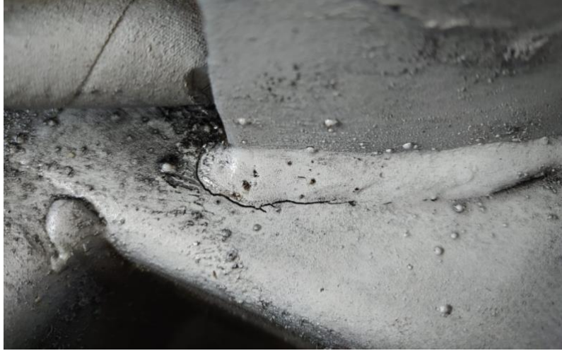
Şekil 13-Bir sepetli platformun tahribatsız muayenesinde tespit edilen çatlak
