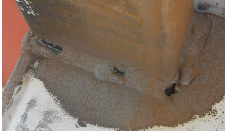
Şekil 6-Görsel muayene ile elde edilen bulgular (Gözenek, doldurulmamış kaynak, nüfuziyet eksikliği)
